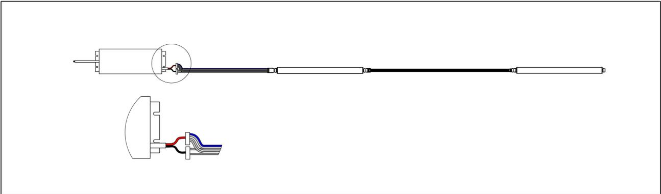
**+36 VDC am Netzteil mit den Adern 1 (blau markiert), 2, 4 und 5 des Leuchtenanschlusskabels verbinden**
