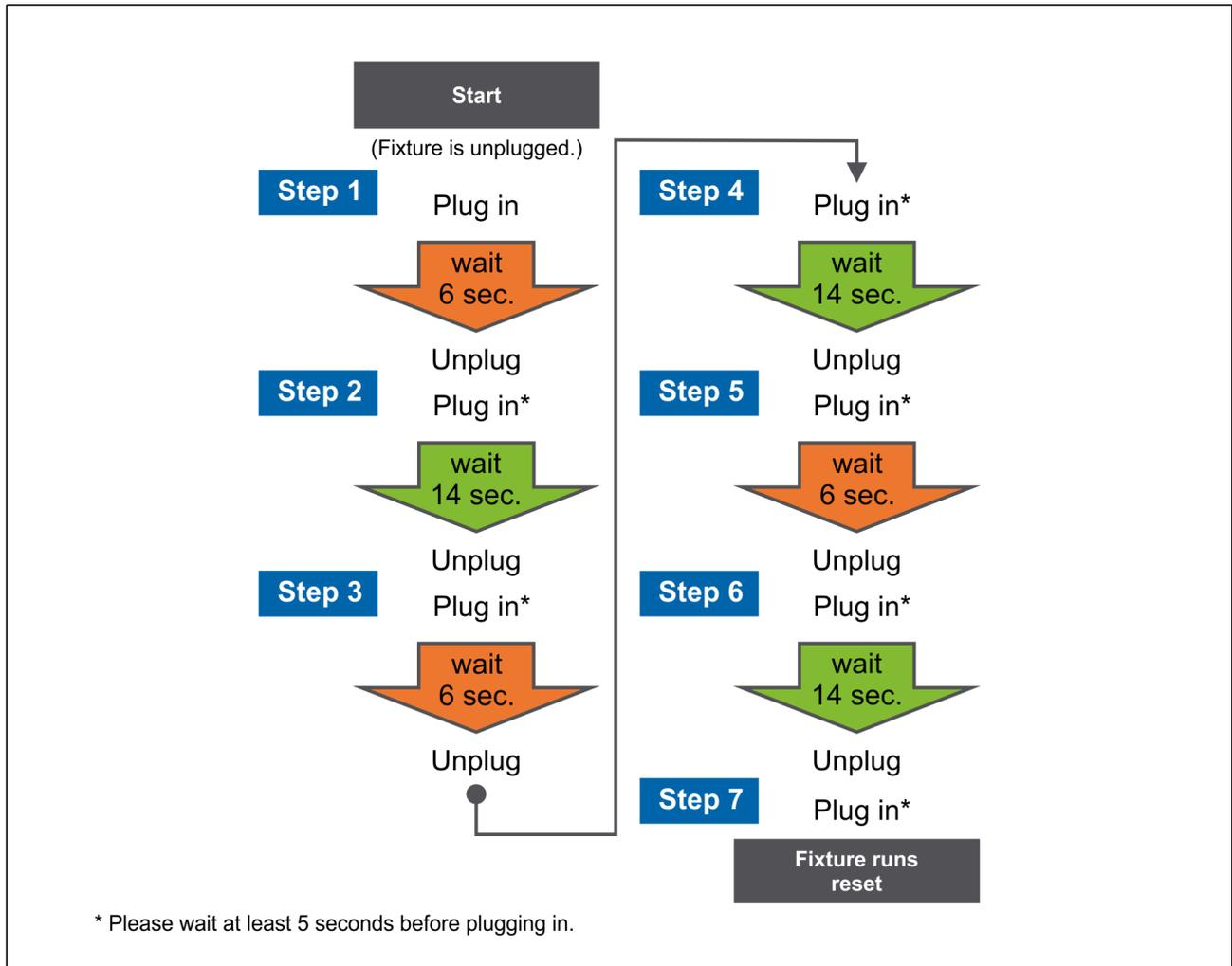
Falls ein BION TECHNOLOGIES IOTcontrol Gerät nicht mehr reagiert, überprüfen Sie zunächst, ob das Gerät richtig verdrahtet und mit Strom versorgt ist. Setzen Sie das Gerät für 10 Sekunden stromlos, danach legen Sie wieder Spannung an das Gerät an, um das Gerät neu zu starten.
