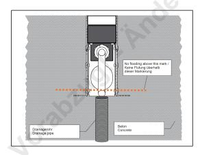
Testen Sie ihr Drainagesystem nach der Installation der Einbaugehäuses aber vor dem Einbau der Leuchte. Das entsprechende Volumen der Bodeneinbaugehäuses in Wasser muss innerhalb von 30 Minuten ablaufen.
